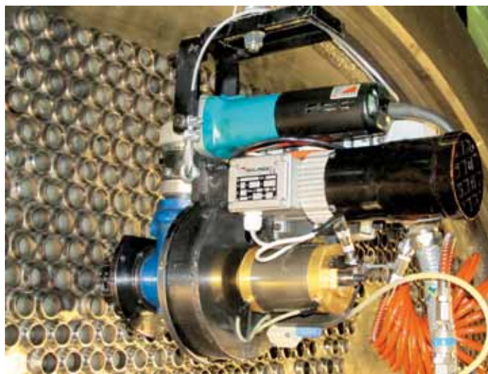
Lavorazione eseguita su STRIPPER composto da n° 4760 tubi di diametro 31,8 x 2,5 mm in materiale grado urea
